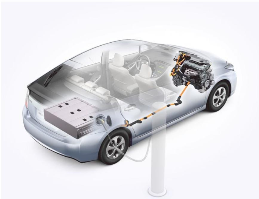
Technik eines Plug-in-Fahrzeugs
