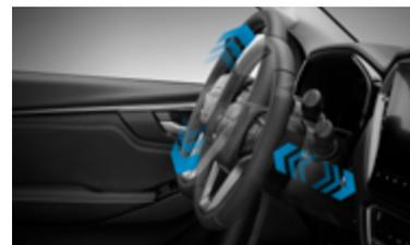
Lenkrad, höhen- und weitenverstellbar
