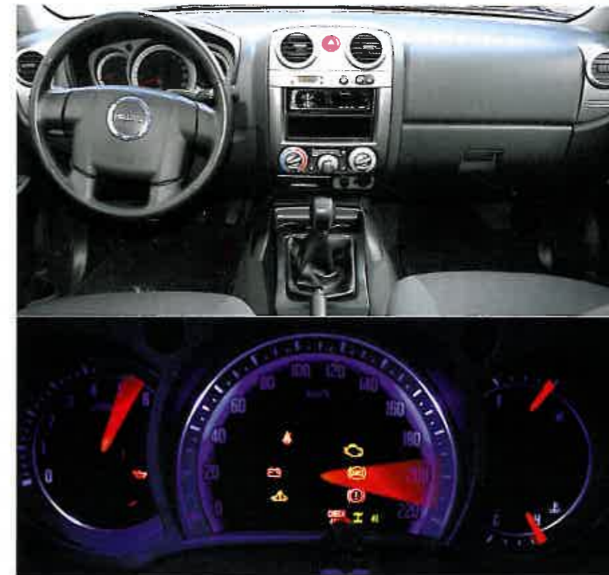
Edel: Silberne Applikationen und eine blau hinterleuchtete Zeigershow. Allrad bis 100 km/h zu- und abschaltbar. Für die Untersetzung muss man anhalten. Beides geht einfach per Knopfdruck
