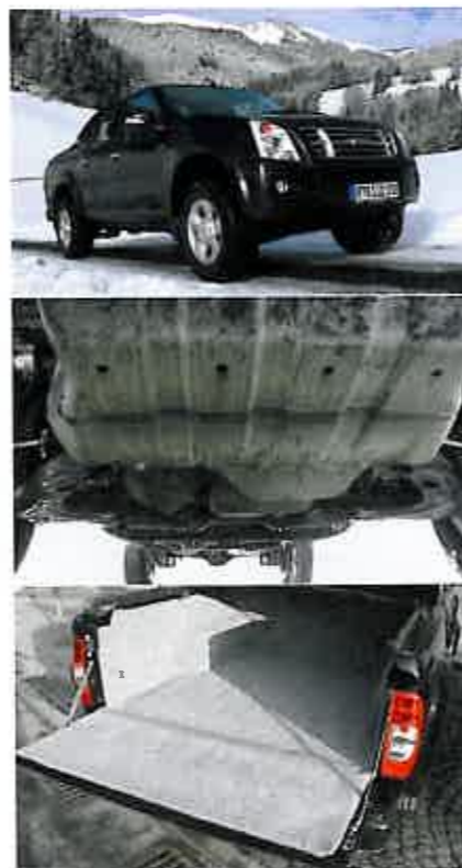
Eine Prallplatte schützt die Ölwanne, hinten gibt es rutschhemmenden Filz und Zurrösen, allzu dreckig sollte die Fracht aber nicht sein
